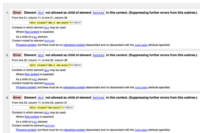
Abb. 4.38: Fehler in Button-Struktur, Quelle: Screenshot des Nu HTML Checkers für <https://groenwald-thesis-bootstrap.netlify.app/> (abgerufen am 10.09.2021)
