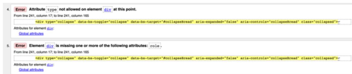
Abb. 4.39: Fehler in `collapse`-Komponente, Quelle: Screenshot des Nu HTML Checkers für <https://groenwald-thesis-bootstrap.netlify.app/> (abgerufen am 10.09.2021)
