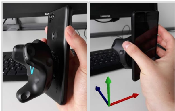
Abbildung 2: Smartphone inklusive befestigtem Vive Tracker. Rechts: Zuordnung der Achsen: X (rot), Y (grün), Z (blau)
