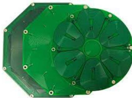
**Beschreibung:** Im Rahmen der Arbeit soll der aktuelle Stand der Forschung zum Thema PCB Motoren beleuchtet werden. Folgend sollen Möglichkeiten und Limitierungen der induktiven Energieübertragung mit hohen Frequenzen über kurze Strecken untersucht werden. Unter Berücksichtigung beider Aspekte soll dann ein Antrieb entwickelt werden der hochfrequente Signale zur Erzeugung eines Drehmomentes nutzt. Ziel der Auslegung ist die Ermittlung der Limitierungen des Technologiekonzeptes.
