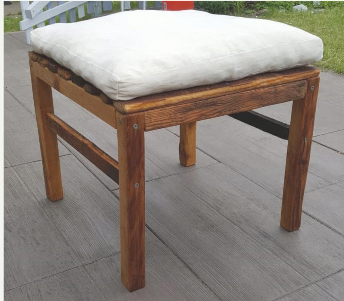
Im letzten Schritt während dem Herstellungsprozesses erhielt der Prototyp seine Imprägnierung mit dem Leinöl. Hierdurch wurde das Holz dunkler, was den bereits erwähnten rustikalen Look zusätzlich unterstützt.
