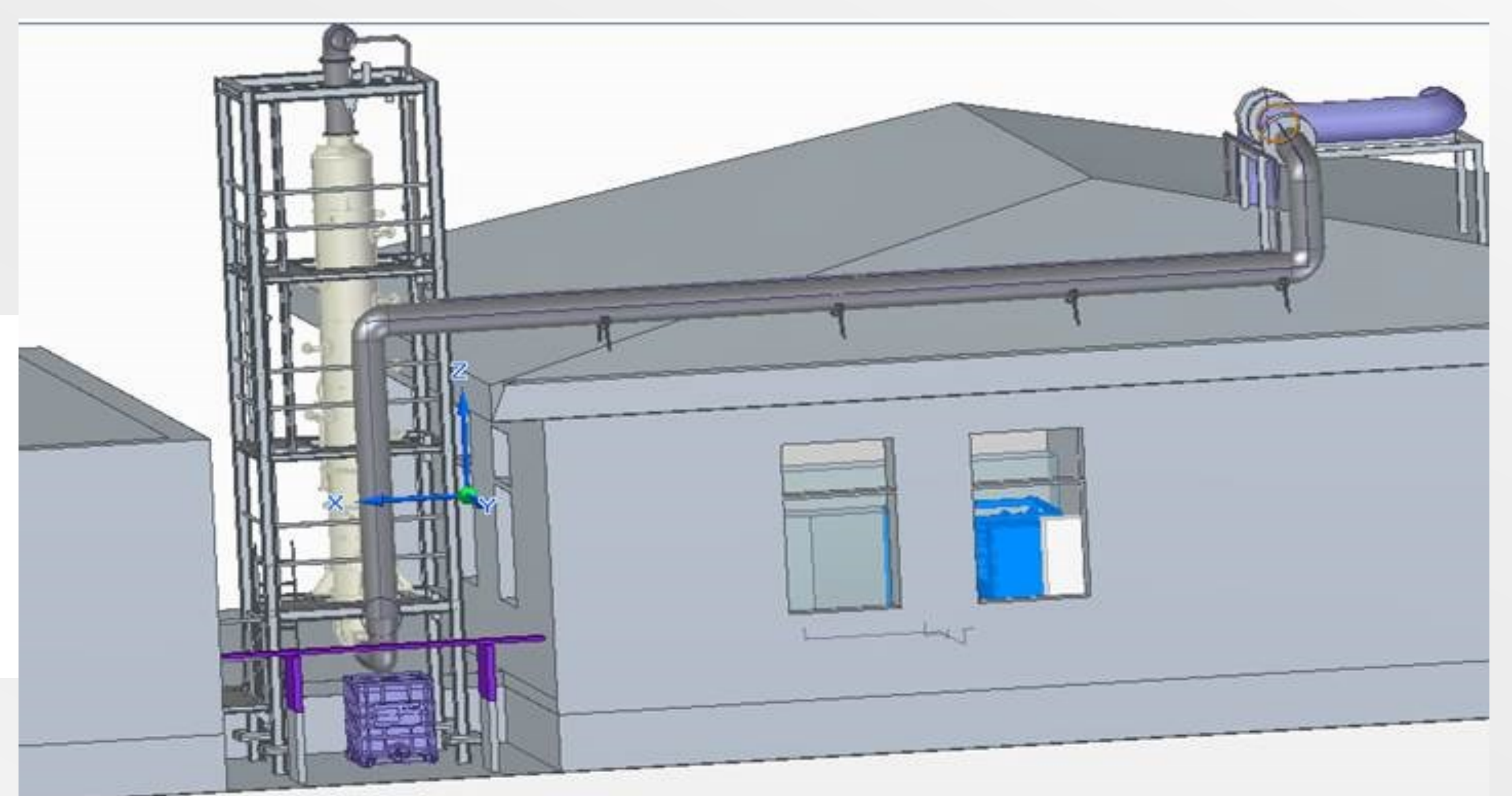
Scrubber in Traggerüst, Zulieferung des Projektpartners PureteQ A/S
