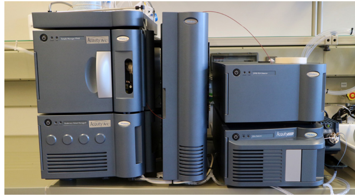
Abbildung 4: Das UHPLC-UV/Vis-MS-System ist ein Benchtop-Gerät der Firma WATERS. Die Kombination von chromatographischen und spektroskopischen Verfahren ermöglicht schnelle und präzise Analysen für die Lebensmittel- und Biotechnologie.
