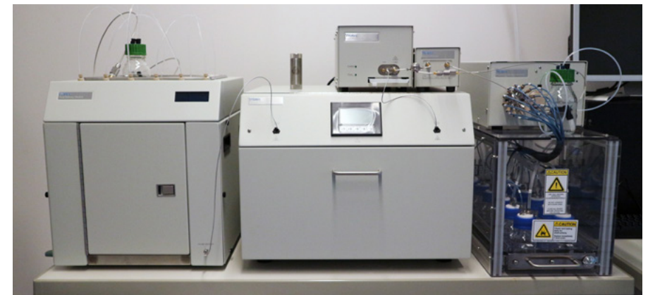
Abbildung 3: Das MV-10 ASFE System von WATERS ermöglicht die kontinuierliche Extraktion von Proben mittels \text{CO}_2 .
